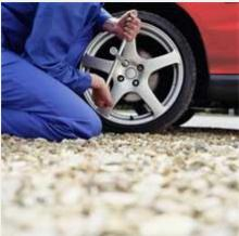
Si sus neumáticos presentan un grado de desgaste mínimo, es decir que la profundidad de las ranuras principales está al máximo, pero que necesita cambiar un neumático deteriorado por un pinchazo o un accidente, debe reemplazarlo obligatoriamente por el mismo neumático. El neumático nuevo deberá contar con las mismas especificidades del anterior y ser de la misma marca, tener el mismo perfil/estructura, mismos índices de velocidad/peso y por supuesto las mismas dimensiones.
